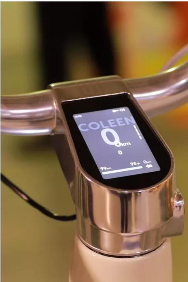
Un écran de 3,2" (en 480 x 800 pixels) est également intégré au guidon : en plus des informations classiques (vitesse, état de la batterie, distance...), il permettra d'afficher géolocalisation GPS, alertes d'appels ou messages...
