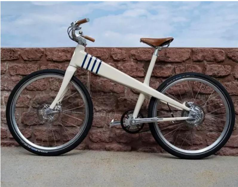
Côté batterie (également fabriquée en France), on retrouve ici un bloc de 529 Wh, pour une autonomie d'environ 100 km, selon le constructeur. La transmission se fait par courroie, et le vélo, d'un poids de 18 kg, est équipé de freins hydrauliques à disque.
