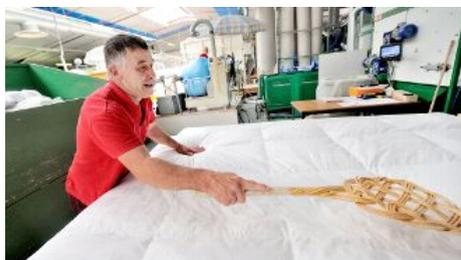
Sur le plan de travail, la couette est battue à la main afin que soit réparti parfaitement le garnissage de l'enveloppe de tissu.
