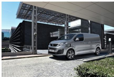
En termes de recharge, on trouve, de série, un chargeur monophasé de 7,4 kW. En option un chargeur triphasé de 11 kW fera le bonheur des professionnels. Voici tous les temps de recharge du Peugeot e-Expert :
