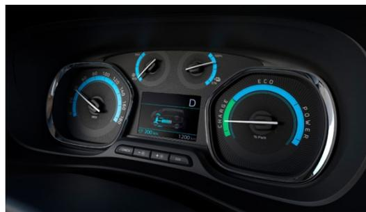
L'habitacle du Peugeot e-Expert fait apparaître de nouveaux équipements propres à son rang de véhicule utilitaire 100% électrique. On remarque ainsi la présence d'une instrumentation spécifique de type « powermètre » avec trois niveaux de consommation : « Eco » (optimisation d'énergie), « Power » (puissance maximale) et « Charge » (récupération de l'énergie). Un petit écran LCD fait apparaître les transferts de flux d'énergie mais, précisons que, pour le reste, les compteurs sont analogiques.
