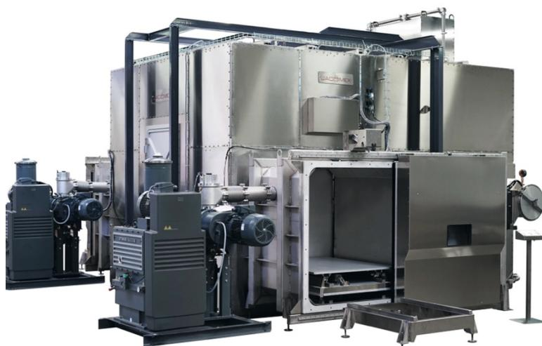
Jacomex met au point des boîtes hermétiques allant jusqu'à 150 m<sup>3</sup> de volume qui permettent de manipuler avec des gants, en toute sécurité, les produits toxiques.
