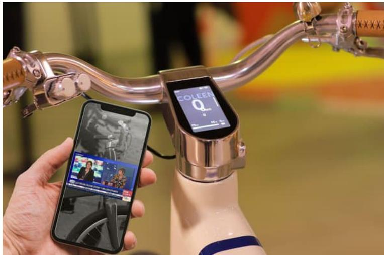
Le tableau de bord du Coleen est connecté à son smartphone via une appli © Coleen. L'appli sert aussi à gérer ses itinéraires avec un GPS, programmer l'éclairage avant et arrière (on, off ou automatique) et à communiquer avec l'écran du vélo sur lequel s'afficheront les SMS et les appels entrants. Cet écran de 3,2 pouces extrêmement lumineux préviendra si le téléphone doit être rechargé. Une prise USB placée sur le côté permettra de le faire.
