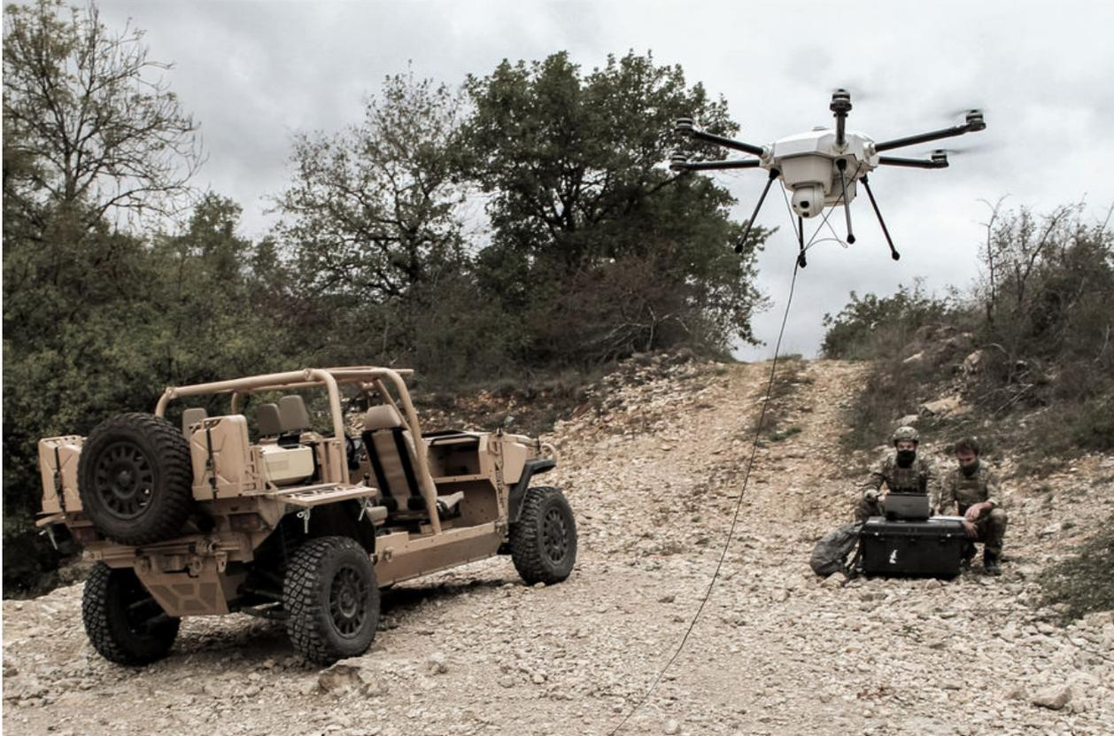
À la différence des drones classiques, Orion 2 est relié par un fil à une station d'alimentation au sol.
