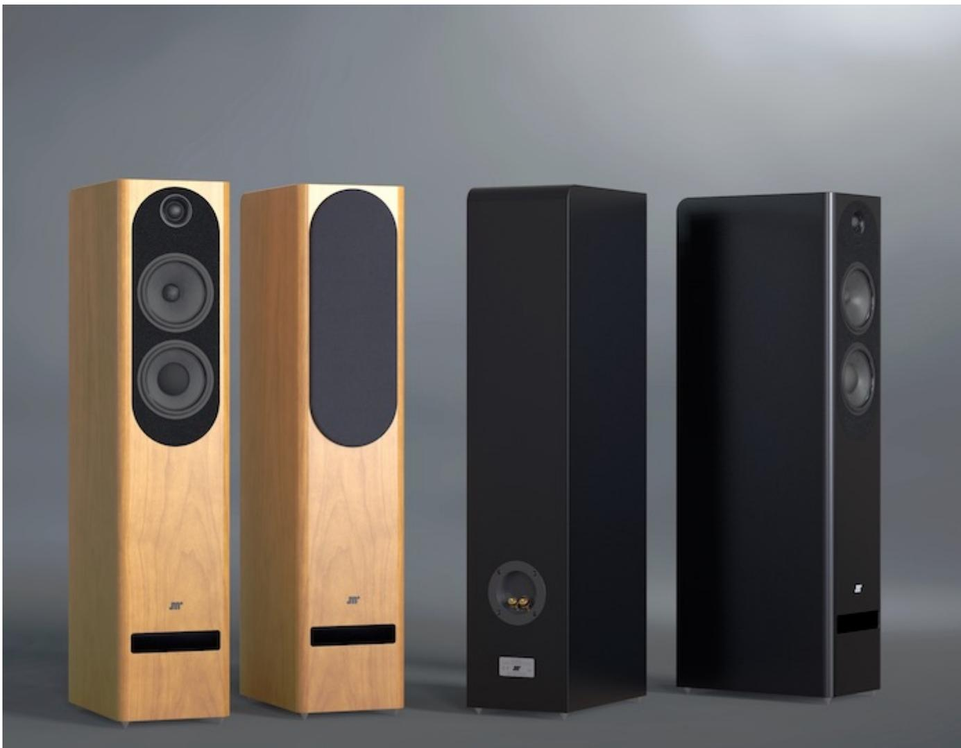
En partant du haut de son baffle, on trouve tout d'abord un tweeter à dôme textile imprégné de 25 mm, puis un transducteur de médium-grave et un boomer, quasiment identiques de 13 cm de diamètre à membrane en papier traité, à fibres longues.
