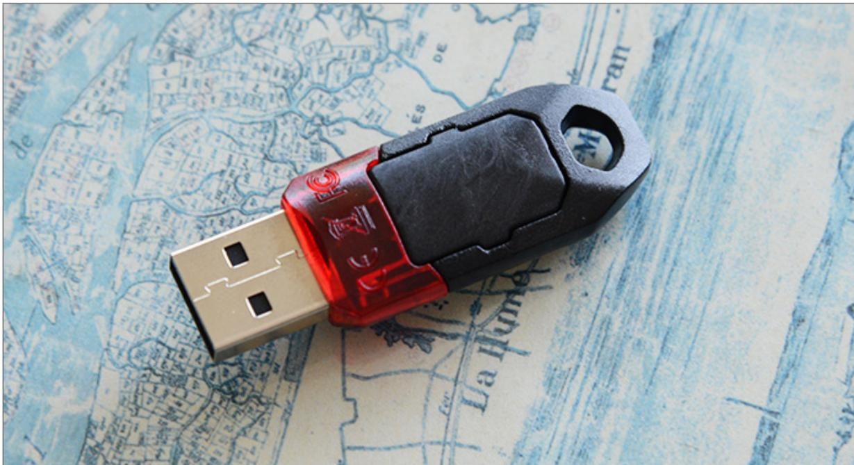
Une fois connectée au port USB d'un ordinateur la clé dévoile des leds bleus et vertes suivies d'un clignotement en rouge lors que l'on est invité à toucher la clé pour confirmer une opération.
