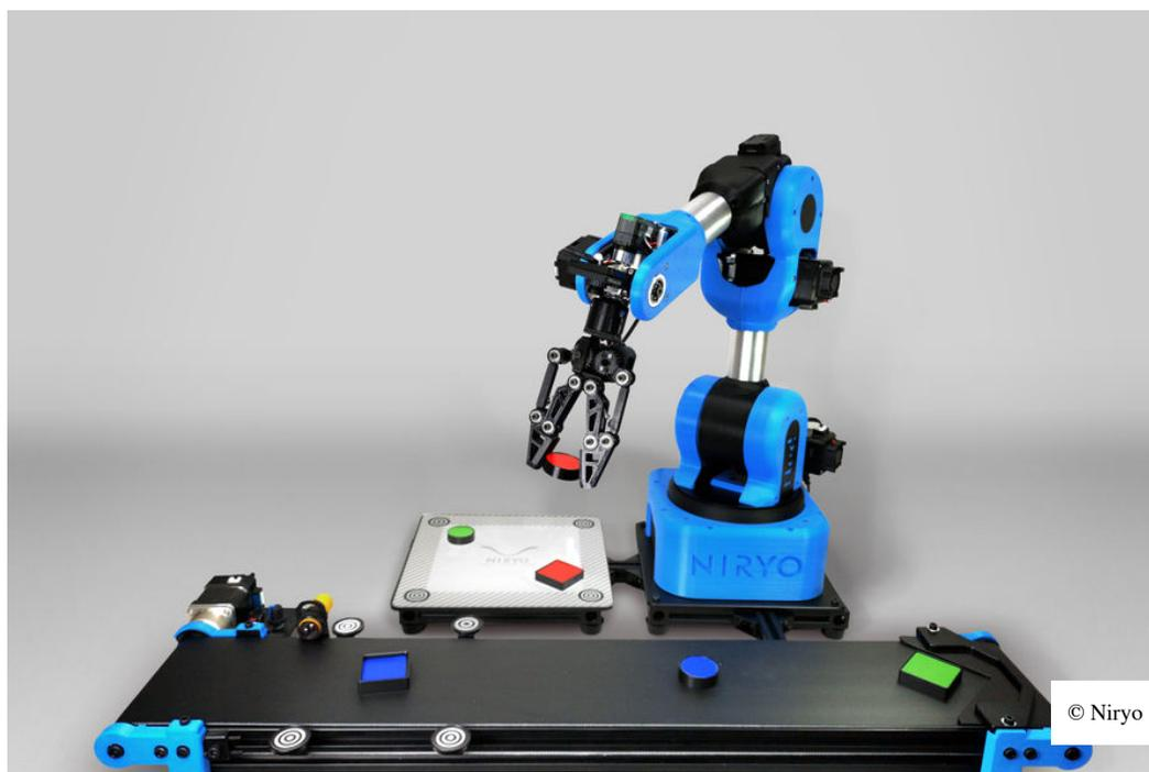
Pour assurer la fiabilité du robot Ned, destiné aux laboratoires et à l'expérimentation, Niryo s'est en partie détourné de l'impression 3D de plastique au profit d'une structure en aluminium
