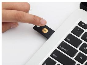
La clé USB de sécurité Yubico YubiKey 5 NFC permet d'utiliser la double authentification sur de nombreux services en l'utilisant sur une prise USB ou via la technologie NFC. Cela permet de s'affranchir des vérifications alternatives comme celles envoyées sur smartphone par SMS.
