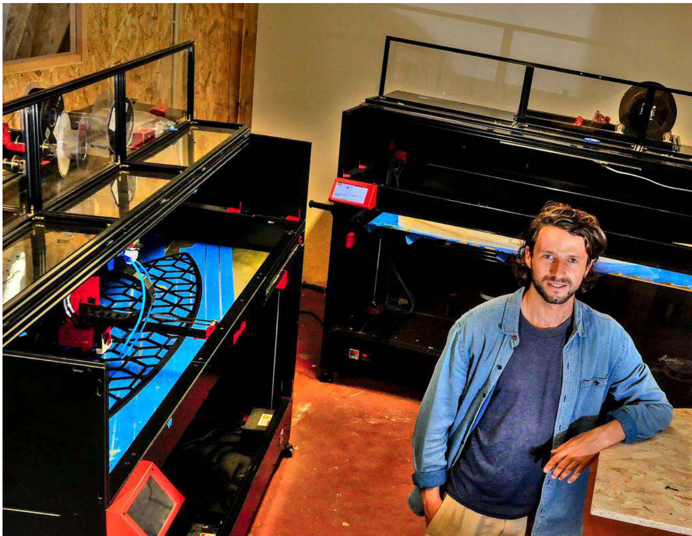
📍 Sylvain Fleury, cofondateur de Wyve surfboard, dans la micro usine où sont installées les imprimantes 3D qui confectionnent les planches de surf en résine bio epoxy. Bertrand Lapègue
