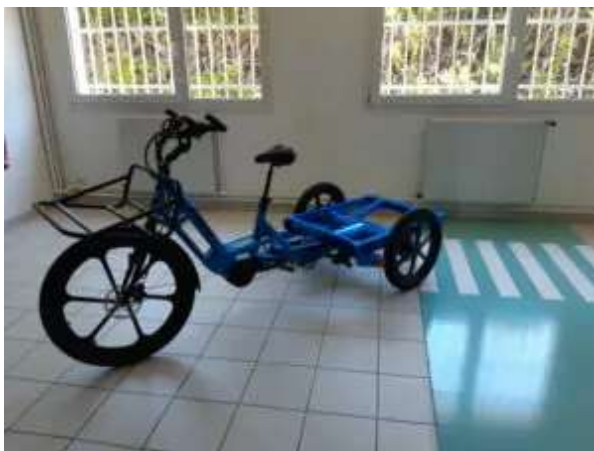
Le nouveau modèle de triporteur capable de transporter 1 mètre cube à plat et d'effectuer une marche arrière © Julien Leprovost/Fondation GoodPlanet
