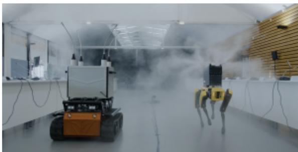
« le Robot Rhyno Protect ». Il s'agit d'un robot de petite taille très polyvalent. Cet appareil est connu pour sécuriser et/ou désinfecter un milieu lors d'un incendie.
