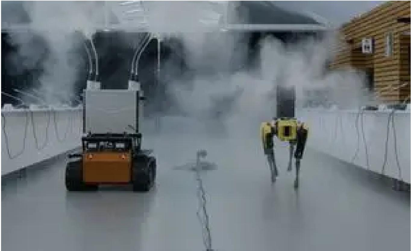
Un robot Rhyno Protect de Shark Robotics (à gauche) et un robot-chien Spot équipés de kits de décontamination contre le Covid-19 — Shark Robotics/Boston Dynamic
