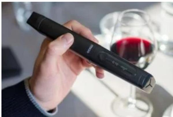
Contrairement à d'autres capteurs qui analysent uniquement l'air ambiant, OCIEngine permet l'analyse de l'air expiré, bien plus complexe, notamment à cause de la forte présence d'humidité et d'interférents. Il peut ainsi, par exemple, mesurer en temps réel la quantité d'alcool dans l'air expiré et détecter les résidus d'alcool dans la
