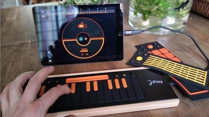
Le périphérique est une base en bois de hêtre qui accueille, grâce à une puce RFID, des modules colorés interchangeables en silicone (Keys, Piano, Drum, Guitar)
