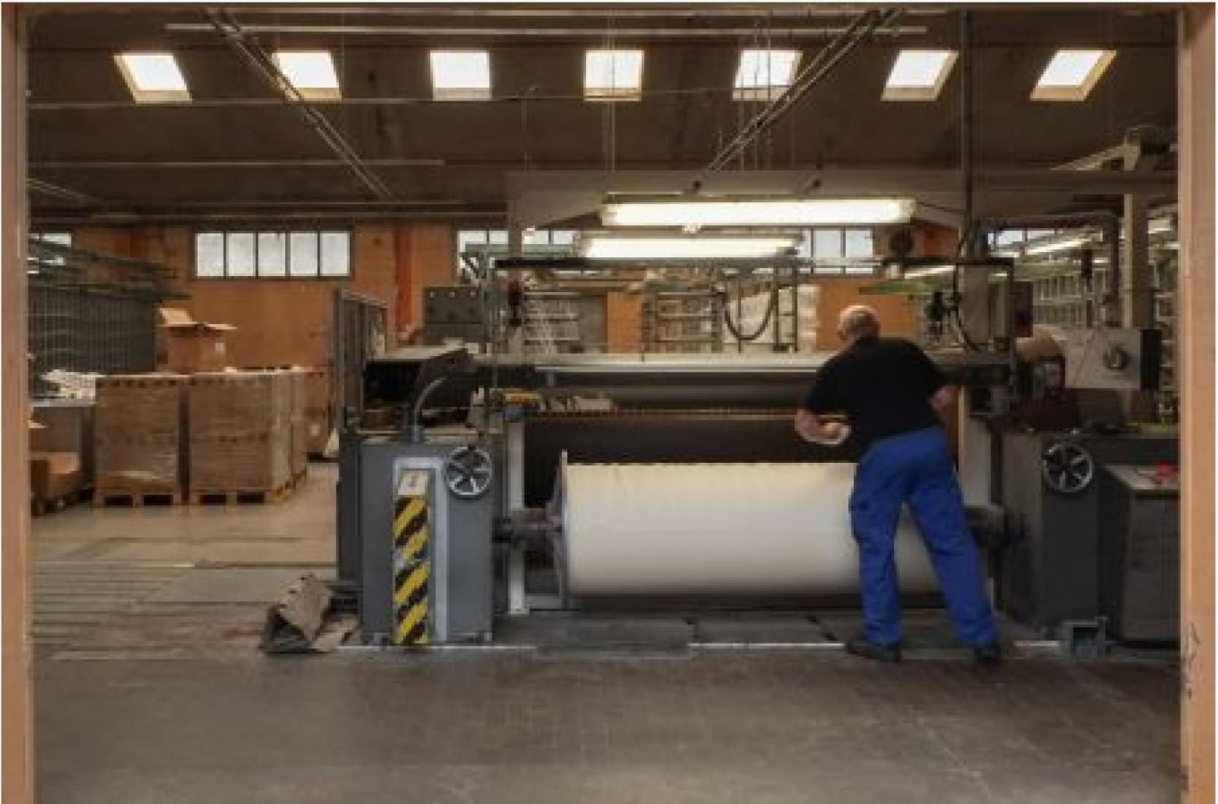
*Un ouvrier d'Emanuel Lang travaille à l'ourdissage du lin, étape qui consiste à défaire les bobines pour enrayer les fils sous une même tension et de manière parallèle selon un ordre précis avant le tissage. Crédit: Agathe Beaujon* Production du lin, filage, tissage, finitions...
