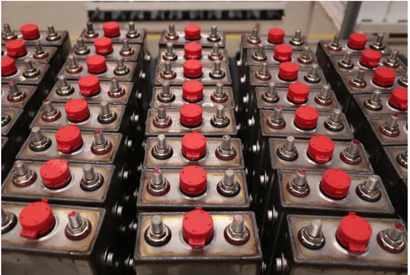
Les batteries SAFT contiennent près de 80-100 kilos de nickel de haute pureté. • © Alain Jeannin
